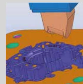
Egal ob aus Kupfer oder Graphit, wir fertigen Elektroden nach Ihren Vorgaben und in kürzester Zeit auf unseren modernen vollautomatisierten **Röders HSC 3- und 5-Achs Bearbeitungszentren**, selbst bei komplexen 5-Achs-Elektroden.
